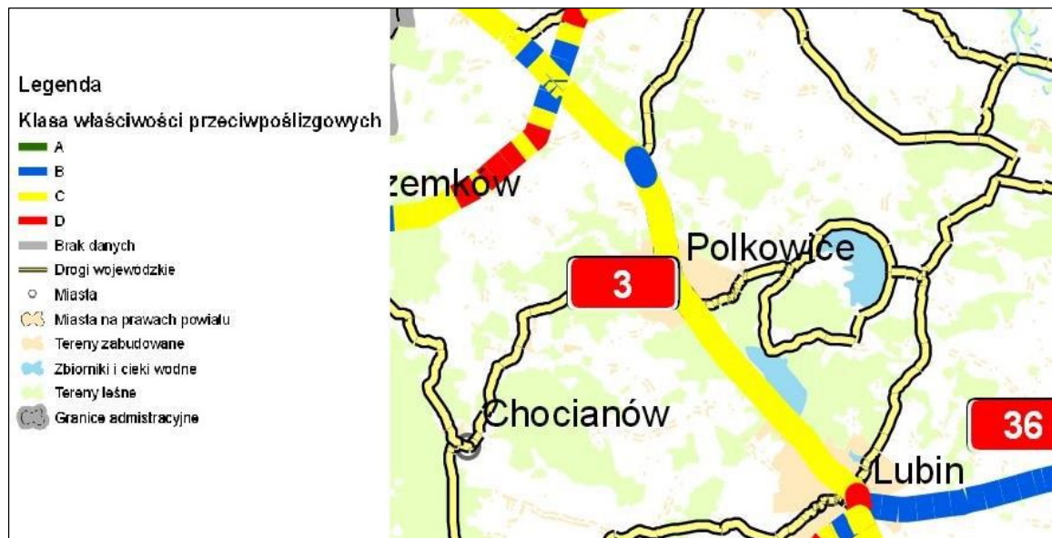
Rysunek 15 Klasa właściwości przeciwpoślizgowych na drodze krajowej nr 3 na terenie Gminy Polkowice w 2013 roku
